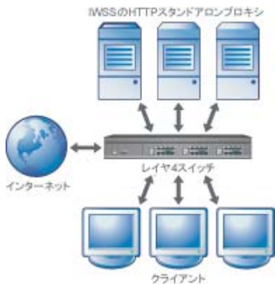
図 5-3. 透過を使用するプロキシ転送
