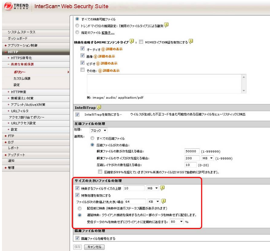
図 7-10. サイズの大きいファイルに対する特殊処理の 2 つのオプション：(1) 配信前に検索と (2) 遅延検索
