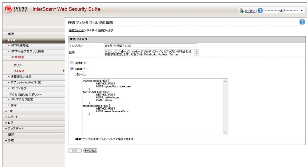
図 7-2. 指定したソーシャルネットワーキングサイトへの POST 処理を防止する HTTP 検査フィルタの設定
