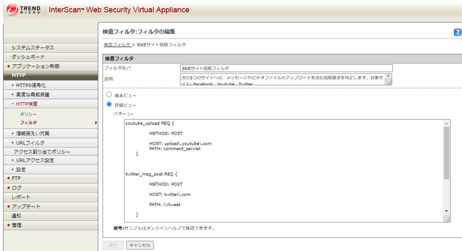
図 8-2. 指定したソーシャルネットワーキングサイトへの POST 処理を防止する HTTP 検査フィルタの設定
